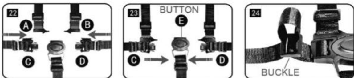
1. Le produit est équipé de ceintures de sécurité à cinq points. Faites glisser la rainure de la ceinture épaillère A à l'endroit correspondant dans la ceinture pelvienne C. Faites de même avec la ceinture B (épaule) et D (bassin).
